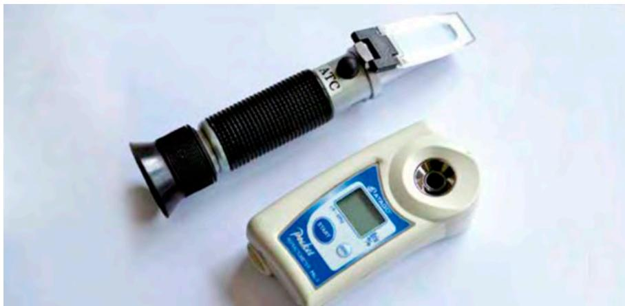
Imagen refractómetro óptico (izq) y digital (der)
