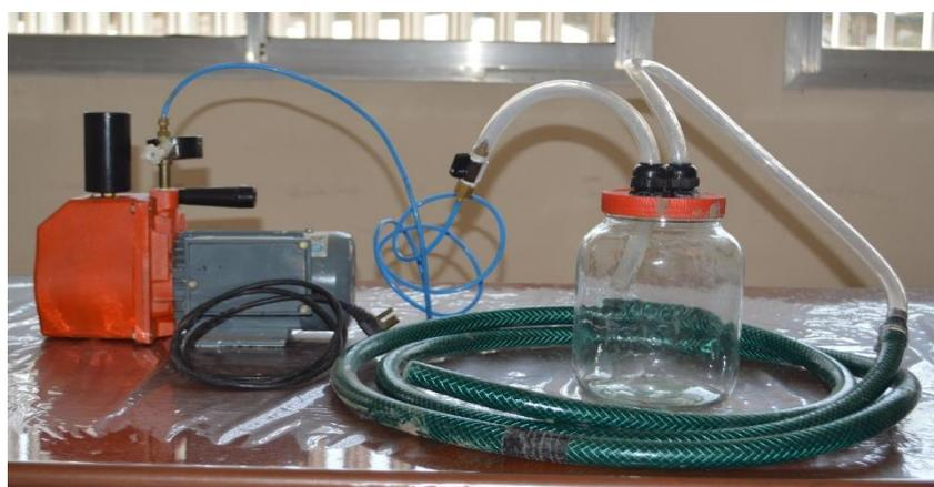
Ilustración 2. Bomba y sistema de vacío propuesto.
