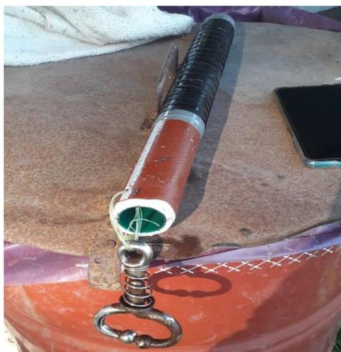
**Ilustración 3.** Modelo de abre bocas. Construido con caño de PVC, protegido en el extremo que se introduce en la cavidad bucal del animal con grip y dotado de mocheta corta para sujeción.
